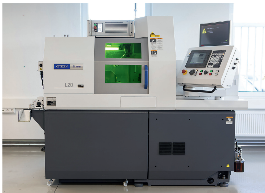
1 Sie kombiniert das Beste zweier Welten: Die Drehmaschine Cincom L20 mit Lasereinheit, speziell codierten Türen und systembedingten Sicherheitsvorkehrungen von Citizen Machinery Europe © Citizen Machinery
